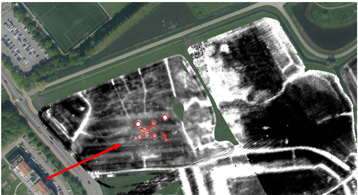
Afbeelding 37: Uitsnede uit de EMI data van het noordwestelijk deel van het terrein met de cirkelvormige structuren. Onder is met behulp van rode lijnen weergegeven waar de cirkelvormige structuren te zien zijn.
