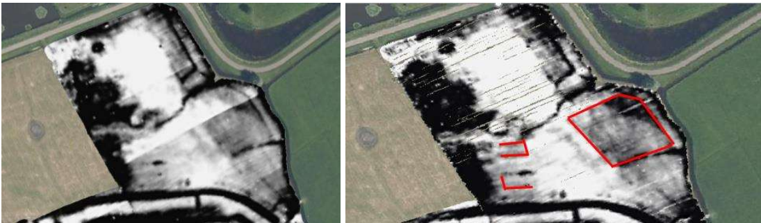
Afbeelding 30: EMI-data overzichtswaergave van het deel van het terrein ten noorden van de omwalling, links onbewerkt rechts met rode lijnen de diverse structuren die op basis van de EMI-data te zien zijn.
