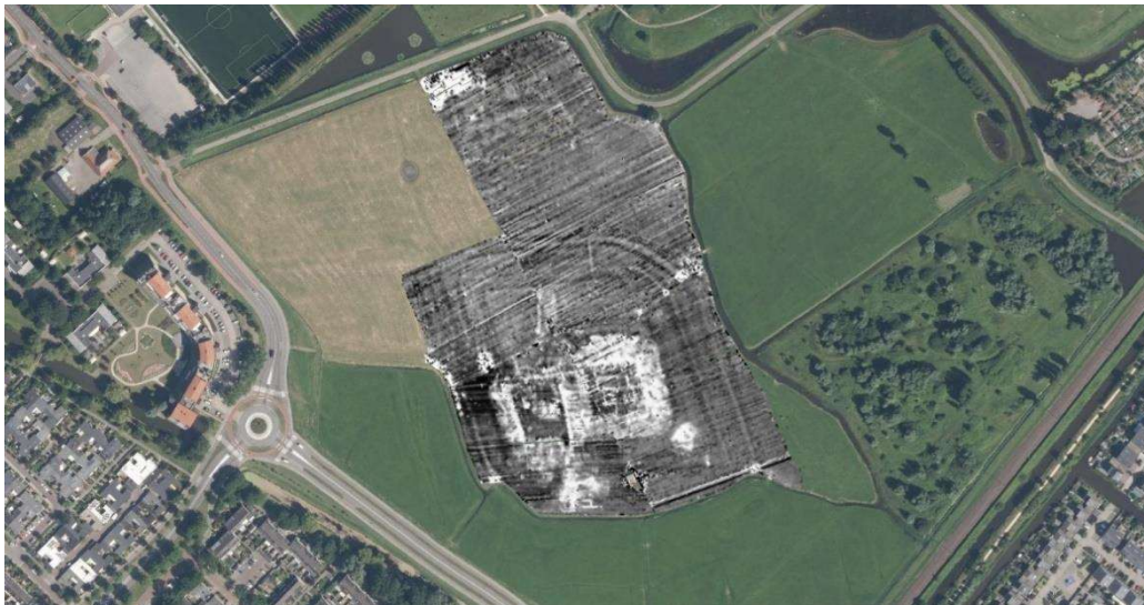
Afbeelding 21: Resultaten EMI meting magnetische susceptibiliteit campagne 2020 Met de EMI meting komen een aantal bijzondere structuren naar voren die duidelijk een andere geleiding vertonen dan de omliggende delen. Voor de interpretatie maken we een onderscheid tussen het feitelijke kasteelterrein binnen de omwalling en het deel buiten het de omwalling: het kasteellandschap.
