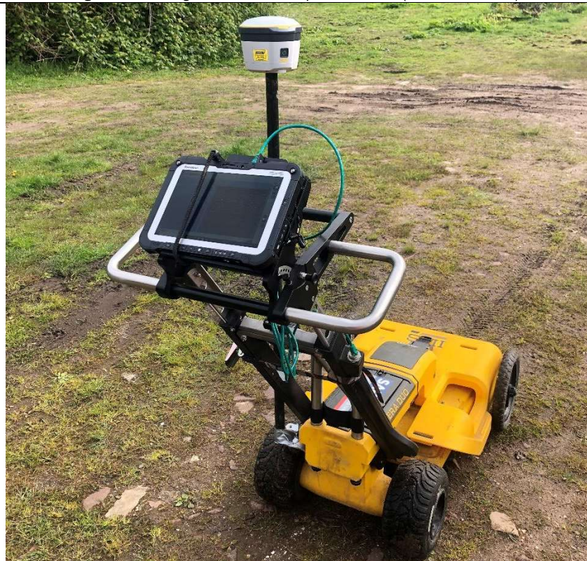
Afbeelding 9: foto van gebruikte GPR (veldwerk 2024)
