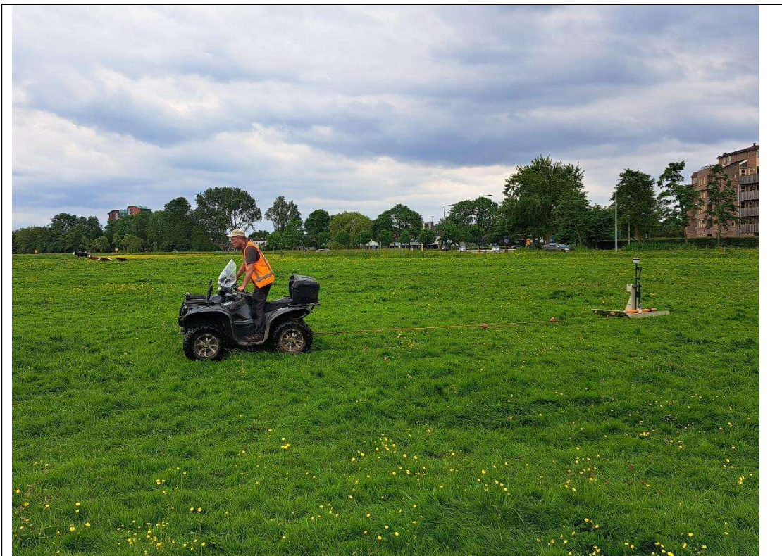
Afbeelding 8: foto van gebruikte EMI - quad en slee (veldwerk 2024)
